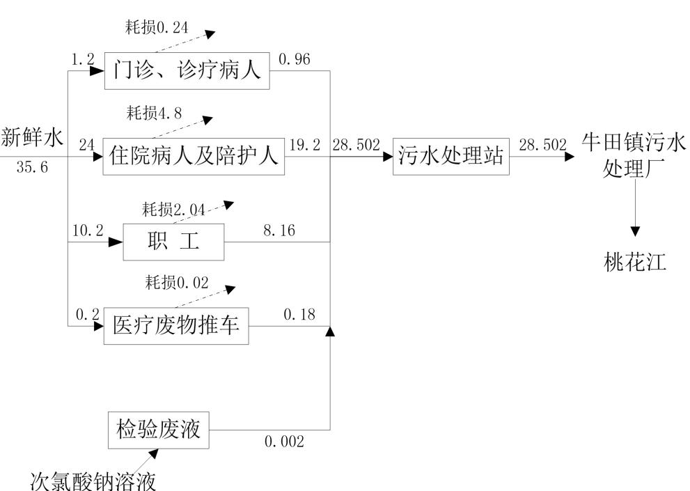
**图 2-1 营运期水平衡图 (单位: m<sup>3</sup>/d)**
